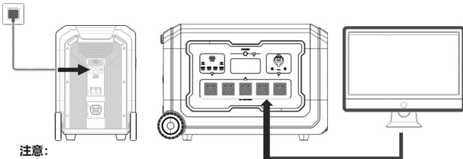
该功能属非专业级的 UPS 功能，不支持 0ms 的切换，请勿接到需要不间断供电要求高的设备上（例如数据服务器和 workstation），或者请多次测试后确认是否兼容后再使用，且使用过程中建议只使用一台设备，不要同时使用多台设备以免引发本产品过载保护，如果没有按照指示操作造成设备不能正常运行或者数据丢失，本司不承担相应的责任。
